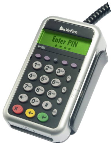
Leitor de cartão inteligente (smart card) e Módulo de Acesso de Segurança (SAM) que suportam transações EMV com proteção avançada de dados
